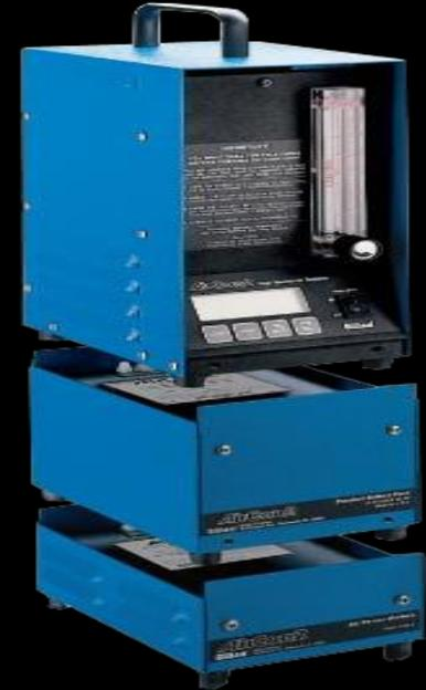
Bomba de muestreo ambiental Gilian Aircon 2 con flujo volumétrico 2-30 L/min para toma de muestras que requieran dicho flujo.
