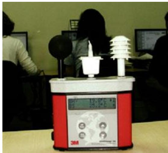
Determinar los niveles de exposición a temperaturas altas o bajas, con base en las normas Colombianas e internacionales vigentes, aplicando los índices recomendados para definir riesgo térmico como WBGT, ITT, TEf, P4SR. y SW Req. Adicionalmente se puede evaluar nivel de confort térmico aplicando normas ISO e índices como PMV y PPD.
