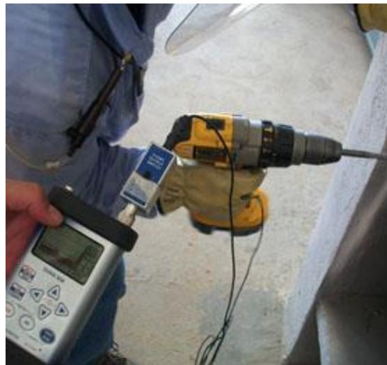
Determinar los niveles de vibraciones y los mecanismos de control implementados, en aquellas áreas en las que se identificó inicialmente la exposición al factor de riesgo, para poder establecer la sobre exposición del personal y sugerir las recomendaciones generales para su control.
